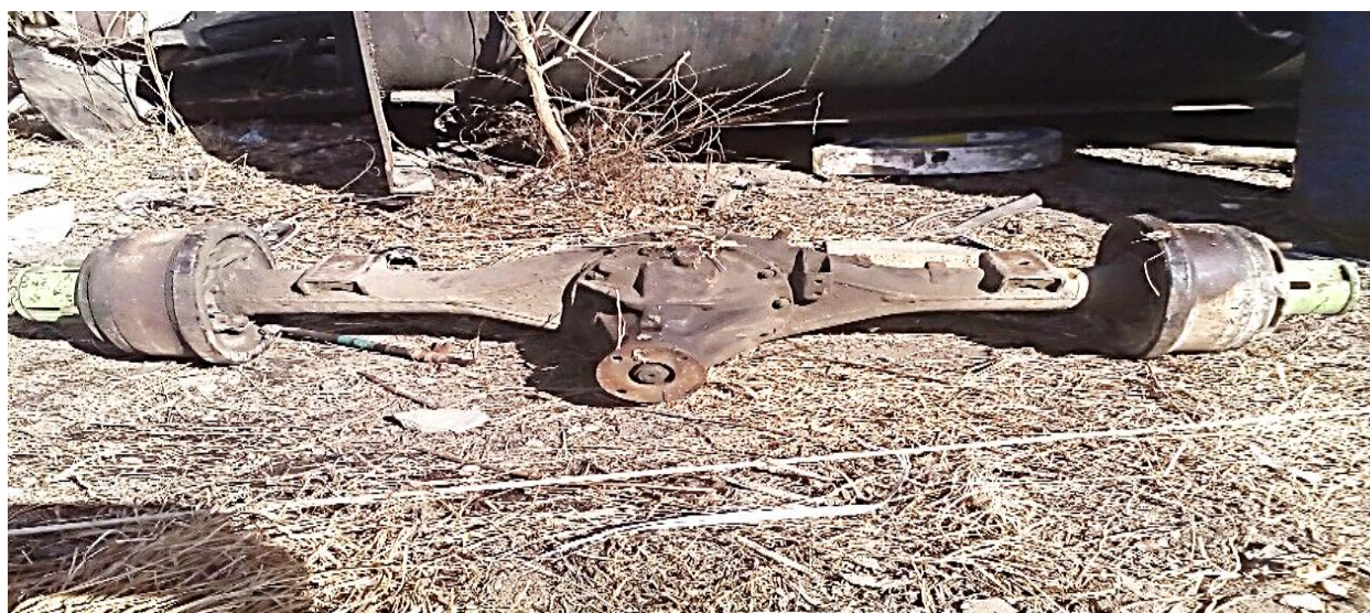
Рис.4. Сочетание нескольких видов изнашивания: механическое абразивное, механическое усталостное и коррозионно-механическое
