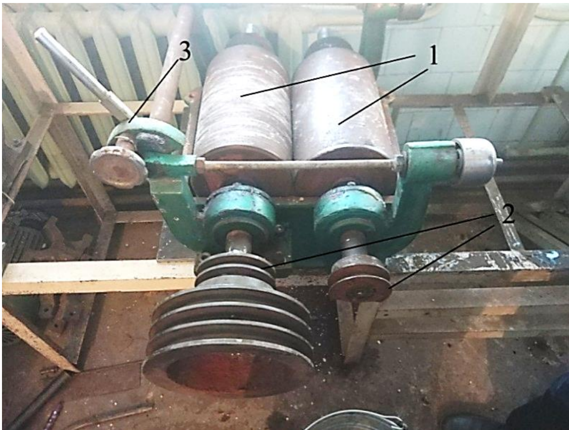
Рис.2. Общий вид плющилки: 1-валцы, 2-привод, 3-рычаг для регулировки зазора валцов
